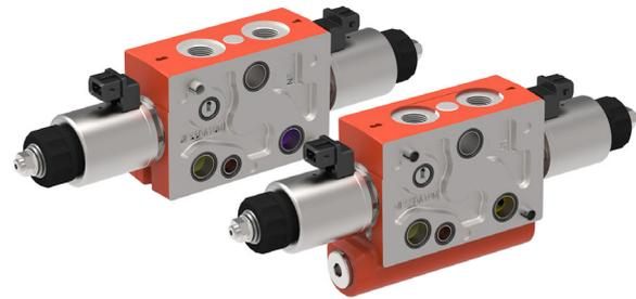
Die Handzusatzbetätigung wird bei der elektrischen Betätigung nicht mitgeschleppt, der Hebel bleibt in seiner Mittelstellung stehen und hat somit keinen Einfluss auf die Kennlinie.
